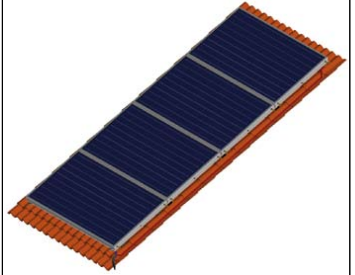
Figura 28 - Esempio di configurazione con quattro collettori sovrapposti.
