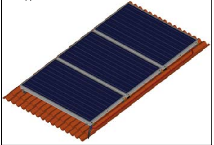
Figura 27 - Esempio di configurazione con tre collettori sovrapposti.
